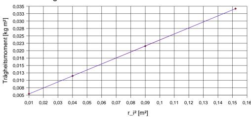
Wären die Hanteln in der Mitte an der Torsionsachse, ergäbe sich folgendes Trägheitsmoment (durch Extrapolation berechnet):
